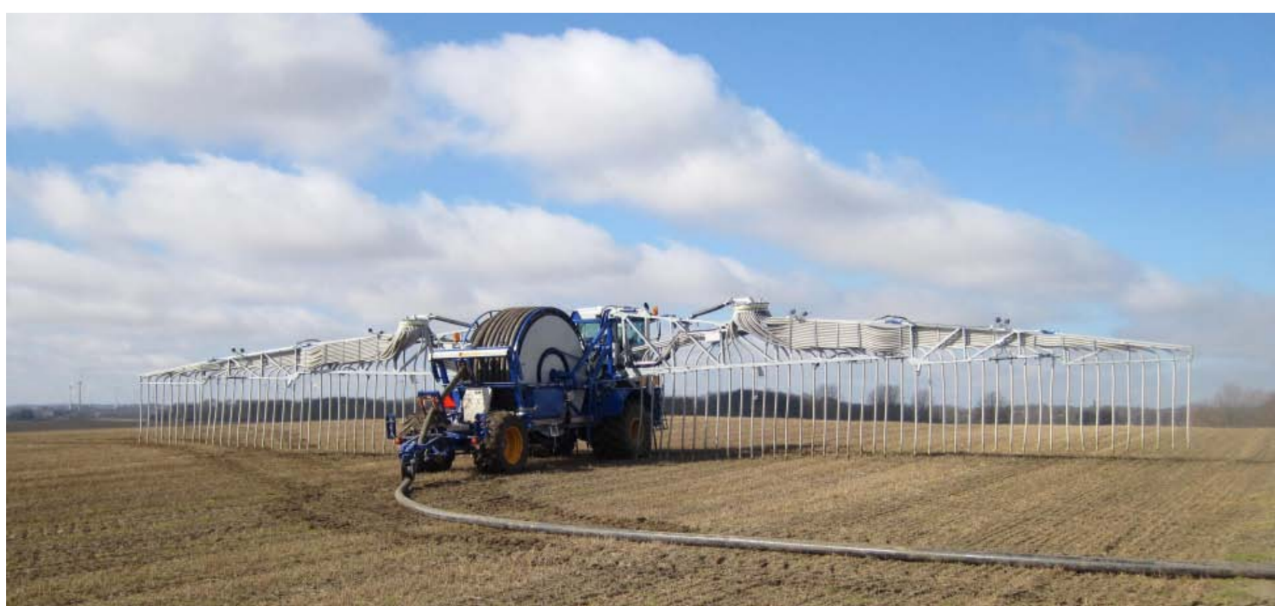
Agrometer mit 500 m Schlauchtrommel, 100 PS
