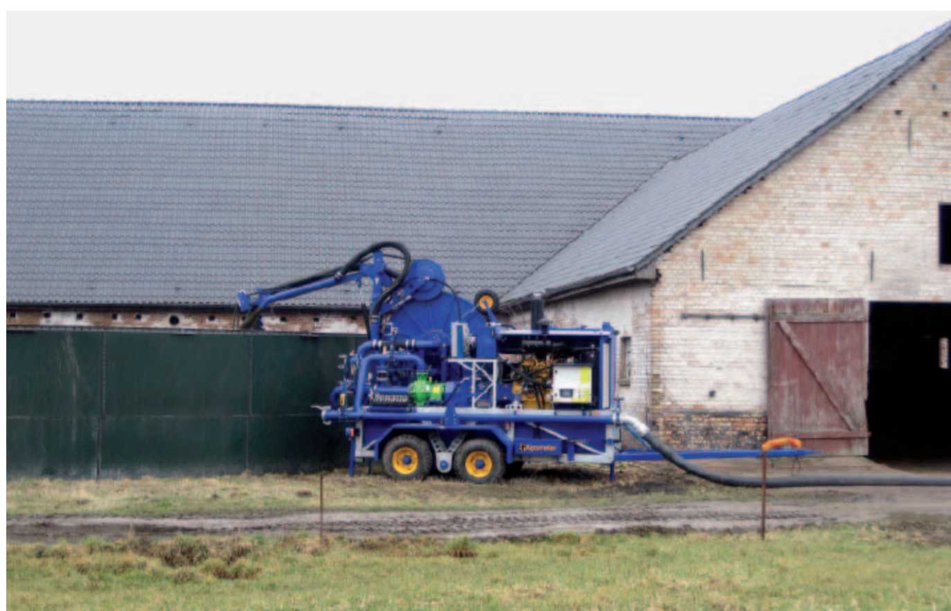
Pumpe 6 Zylinder Dieselmotor 120 PS
